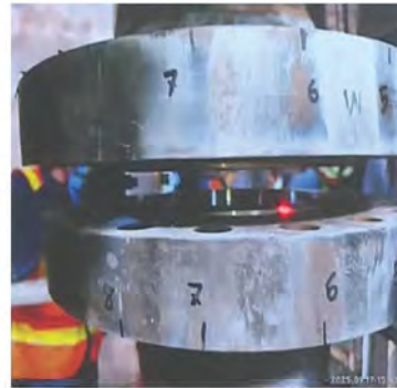
9/17火場調查時，法蘭撐開 後，確認無墊片殘留
