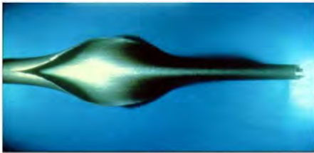
不鏽鋼導管被污染後與氧化劑反應
