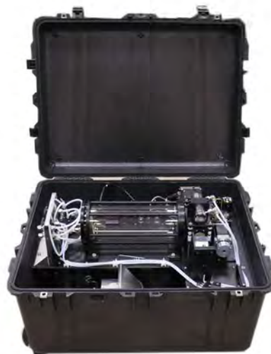
FACE-EB3000 移動抽氣式 FTIR
