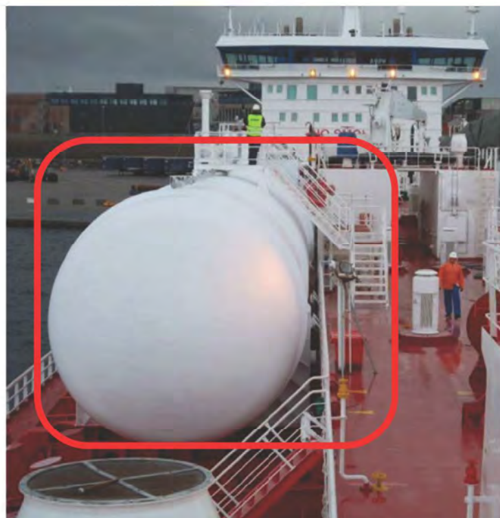
圖1 典型氣體燃料儲槽配置圖
