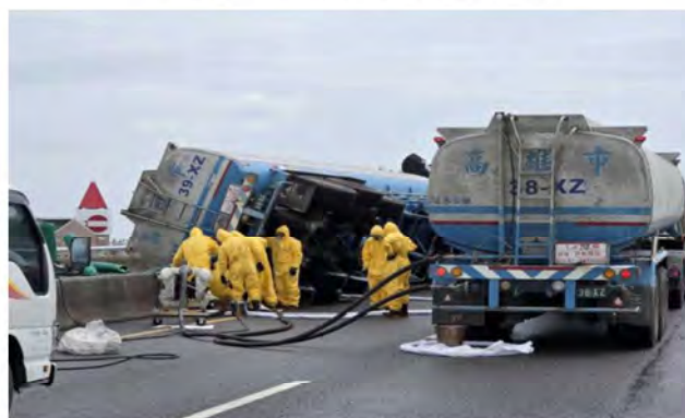
圖六、移槽作業
