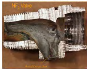
NF 3 在閥門中燃燒 (絕熱壓力 + 污染)
